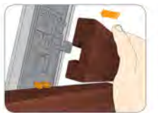
05 Montage des nächsten Holzpaneels
