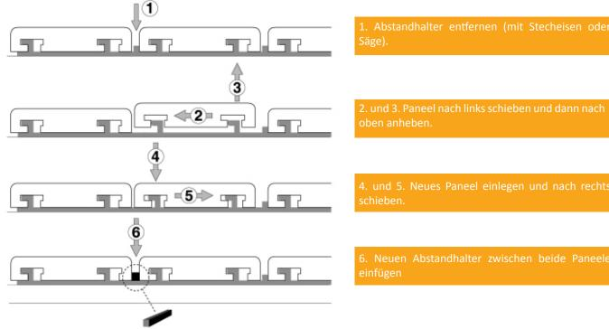
C. Die Verlegung einer vertikaler Gürtel wird mit einer Softline® Klip und mit Hilfe einen zusätzlichen Abstandhalter von 6x5mm ausgeführt. Siehe Zeichnung anbei:
