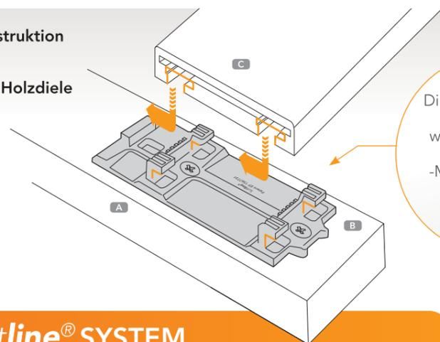
Dieses System wurde aus einem sehr widerstandsfähigen „Komposit“-Material entwickelt und garantiert somit eine lange Lebensdauer.
