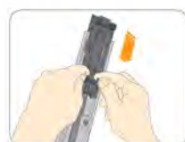
02 Insertion des clips Techniclic® dans les rails
