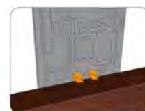
04 Serrage de la lame à l'insertion de la deuxième clip
