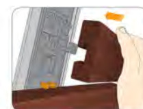
05 Pose de la lame suivante
