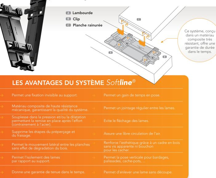
Le système de fixation Softline® permet une libre circulation de l'air et un mouvement latéral entre les planches sans effet de dégradation du bois.
